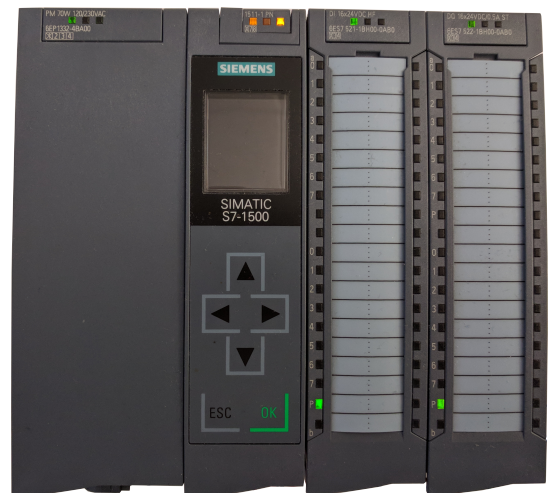
Abbildung 2.1.: Siemens Simatic S7-1500
